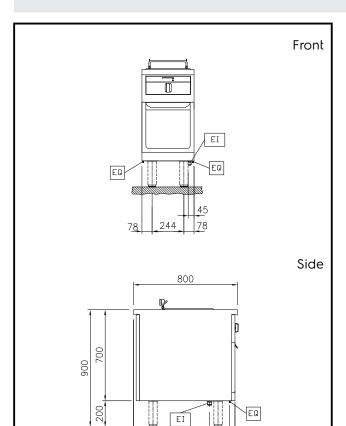
Electrical inlet (power) Equipotential screw
